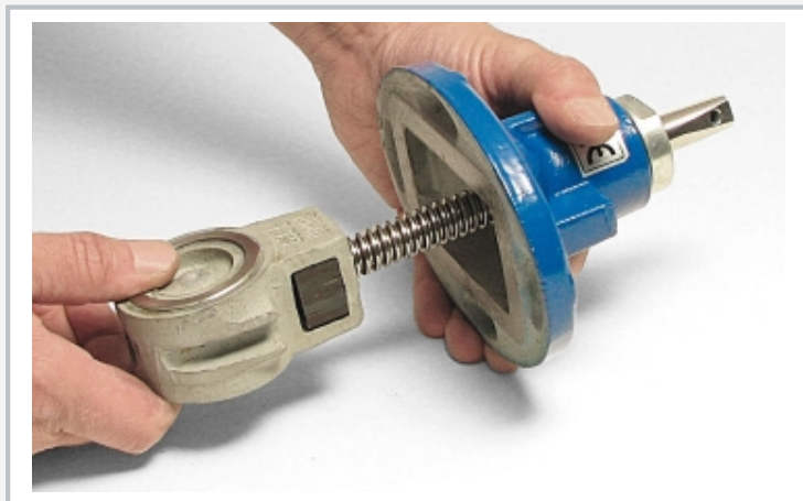
Montage du robinet-vanne
