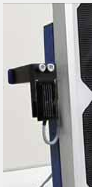
Sensor zur Messung der Beleuchtungsstärke
