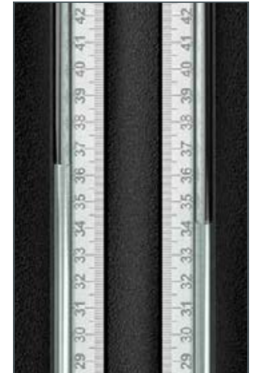
Das Rohrmanometer ermöglicht es, geringe Druckverluste mit hoher Genauigkeit zu bestimmen.
