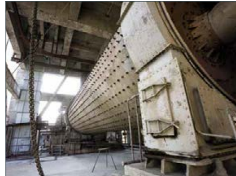
Broyeur à billes industriel utilisé pour la gestion des déchets
