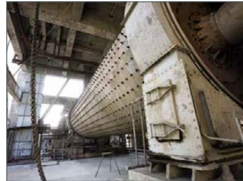
Großtechnische Kugelmühle in der Abfallwirtschaft
