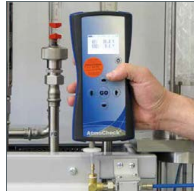
Appareil d'analyse des gaz pour la détermination de la teneur en oxygène et de la teneur en dioxyde de carbone.
