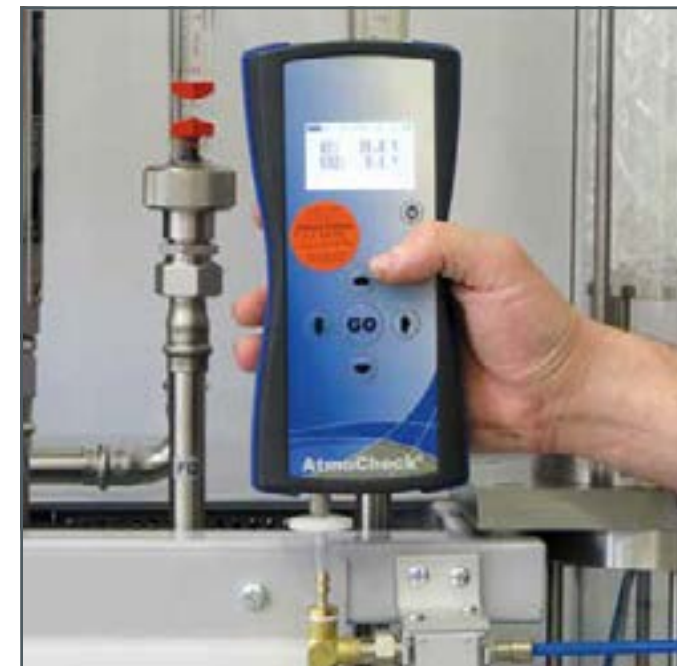
Gasanalysegerät zur Bestimmung des Sauerstoffgehaltes und Kohlendioxidgehaltes.
