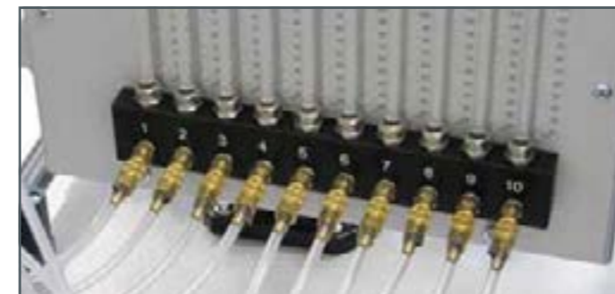
Anschlüsse an der Manometertafel zur Messung des Druckverlaufs im Filterbett
