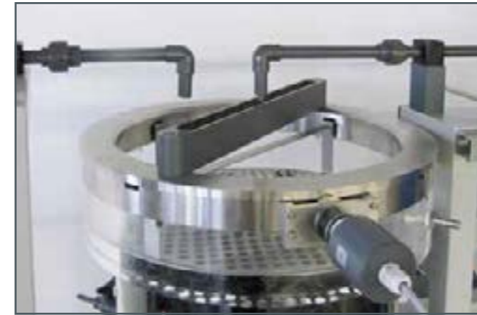
Tête d'arrosage automatique sur le haut du lit bactérien avec ajustage en continu de la vitesse de rotation
