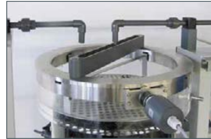
Drehsprenger am Kopf des Tropfkörpers mit stufenloser Drehzeleinstellung
