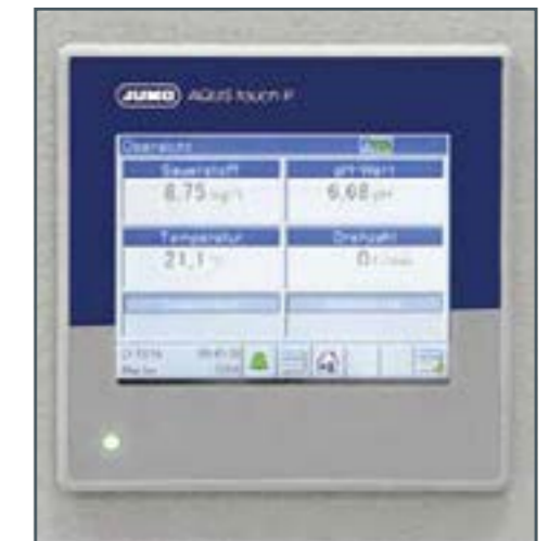
Régulateur numérique de processus indiquant les valeurs de processus et permettant la régulation de la concentration d'oxygène
