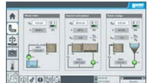
Écran tactile: commande des pompes
