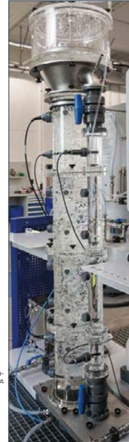
Distributeurs divers pour l'aération du réacteur
