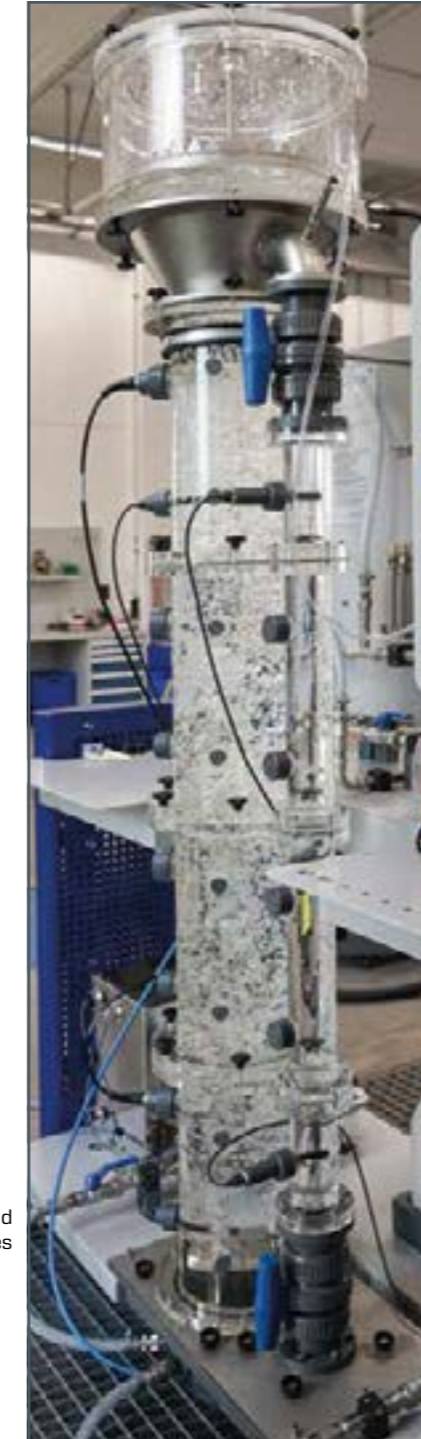
Verschiedene Verteiler für die Belüftung des Reaktors
