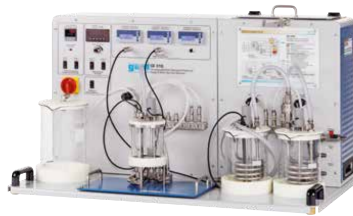
Unité d'alimentation pour les réacteurs chimiques CE 310 avec Cascade de cuves agitées CE 310.03
