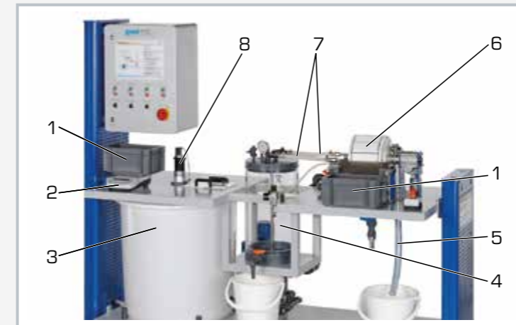
1 réservoir collecteur pour gâteau de filtre, 2 balances, 3 réservoir de réserve à suspension, 4 réservoir à dépression filtrat, 5 trop-plein/sortie, 6 filtre cellulaire à tambour, 7 raccord de dépression, 8 agitateur
