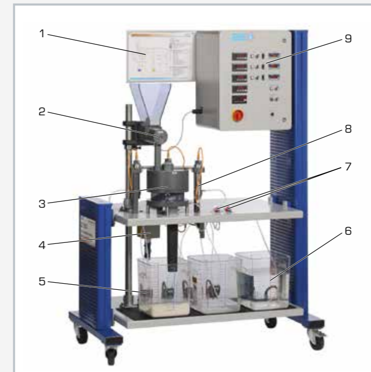
1 schéma de processus, 2 vis sans fin pour le transport de la matière à extraire, 3 extracteur rotatif, 4 unité d'entraînement de l'extracteur, 5 pompe (derrière les réservoirs), 6 réservoir, 7 vannes de sélection du mode de fonctionnement, 8 dispositif de chauffage et alimentation de solvant, 9 armoire de commande avec éléments de commande
