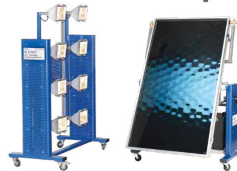
La source de lumière artificielle HL 313.01 avec le capteur plan HL 313
