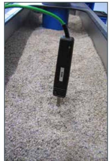
Mesures de température avec une sonde manuelle
