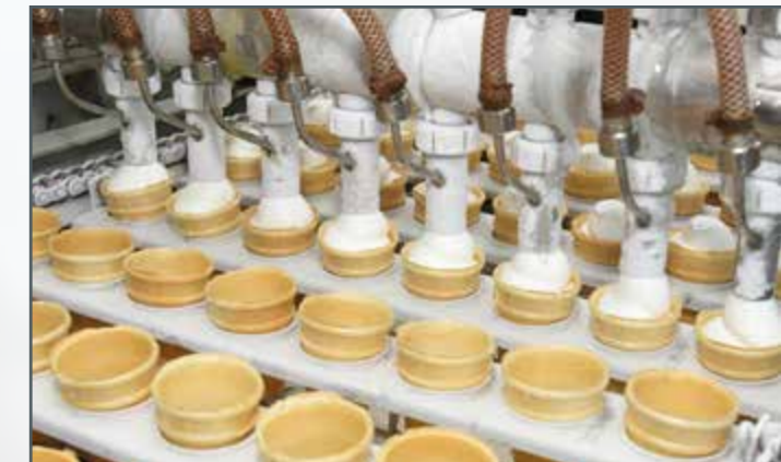
Dans l'alimentaire, les différentes étapes de production nécessitent souvent des températures de consigne très précises. Un défi majeur dans la planification des installations de production consiste à intégrer les installations frigorifiques au reste de l'alimentation du bâtiment de manière à obtenir la meilleure efficacité énergétique possible.
