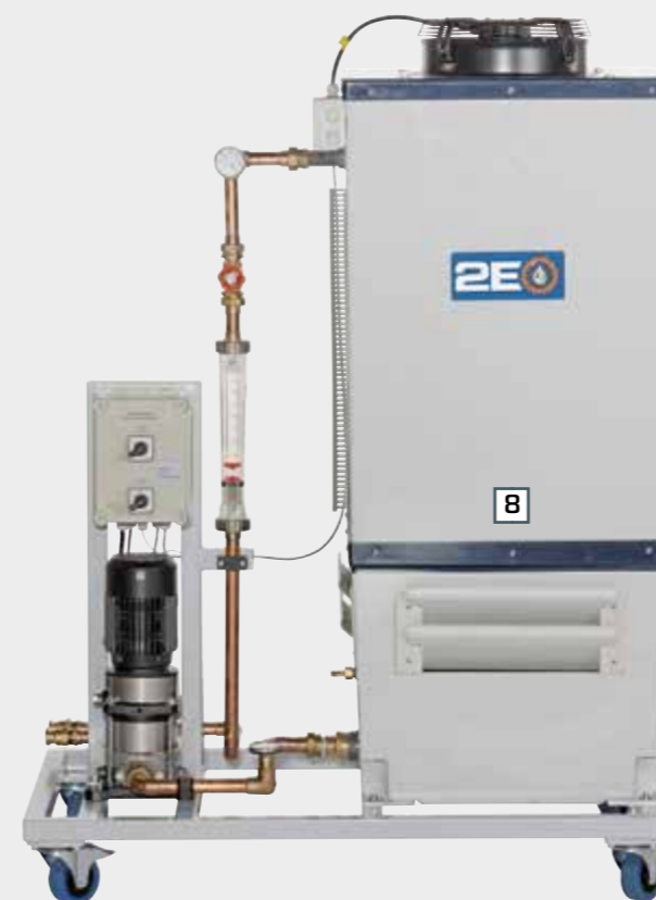
Tour de refroidissement par voie humide
