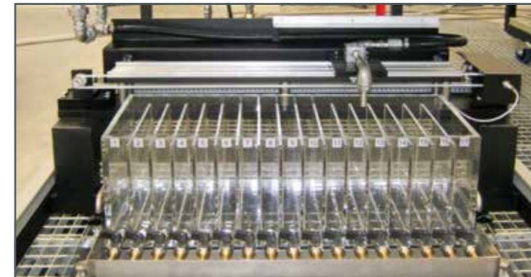
Les chambres de mesure sont remplies de manière programmée l'une après l'autre.
