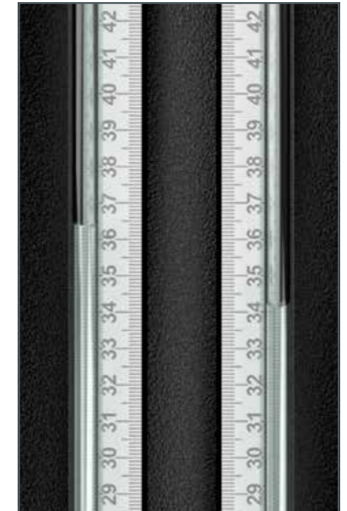
Le manomètre à tubes permet de déterminer de faibles pertes de charge avec une grande précision.
