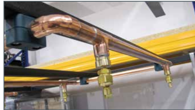
Dispositif de précipitation avec buses pour la simulation réaliste de précipitations
