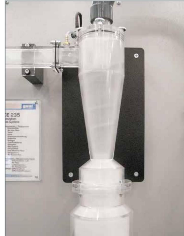
Abscheidung von Quarzfeinstaub im Gaszyklon während des Testbetriebs in unserem Labor. Man erkennt die für Zyklone charakteristische spiralförmige Bewegung der Partikel.
