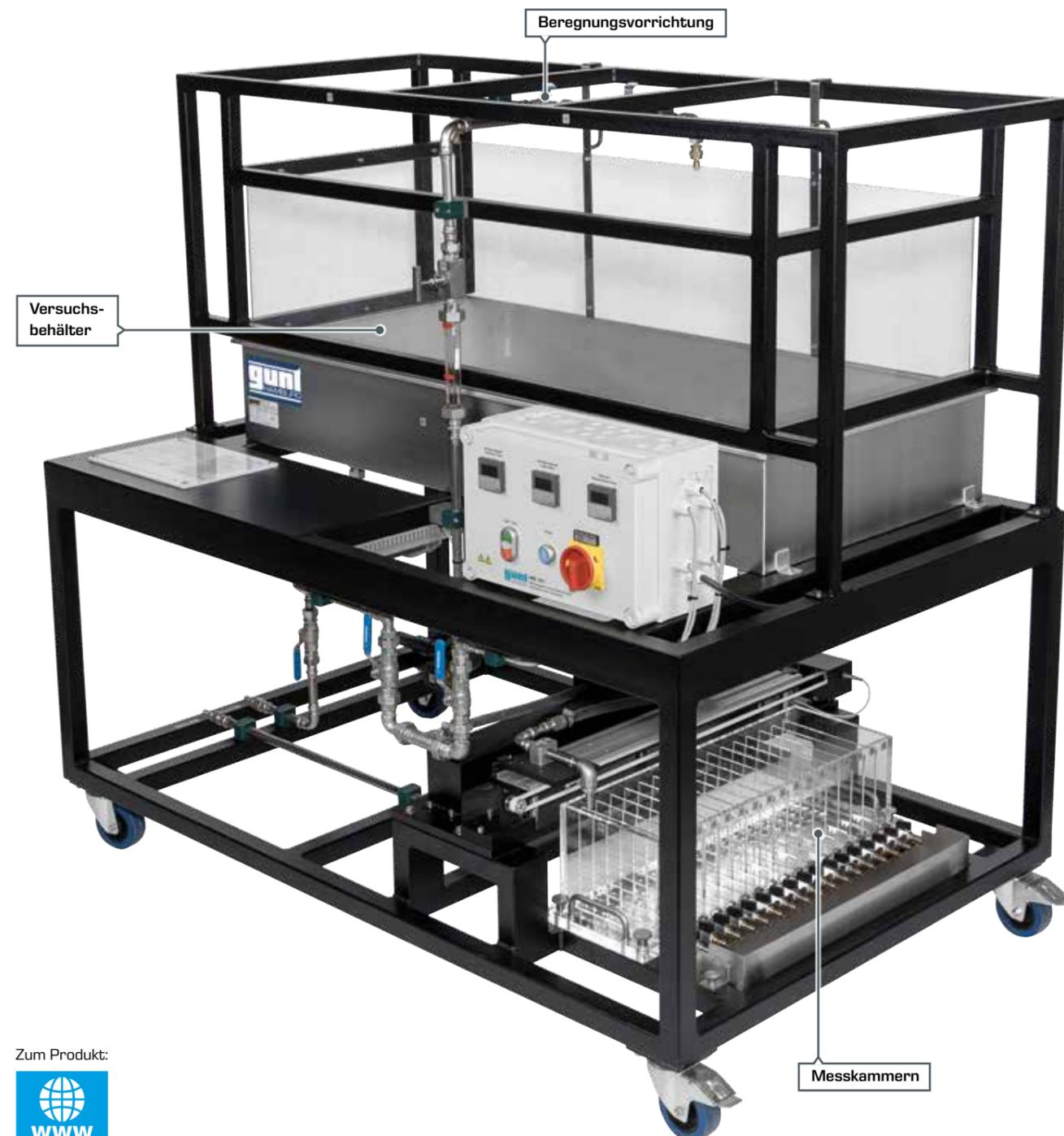
Kernelement von HM 141 ist ein mit Sand bzw. Kies gefüllter Versuchsbehälter. Mittels Zeitschaltuhren können Sie die Versuchsfläche mit Niederschlägen unterschiedlicher Dauer und Intensität beaufschlagen. Die Entwässerung der Versuchsfläche kann wahlweise mit einem Drainagerohr oder einer an der Seite des Versuchsbehälters befindlichen Ablaufkammer erfolgen.
