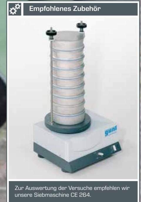
Zur Auswertung der Versuche empfehlen wir unsere Siebmaschine CE 264.
