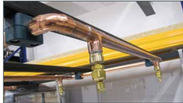
Beregnungsvorrichtung mit Düsen zur realistischen Simulation von Niederschlägen.
