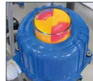
Elektrisch angetriebener Kugelhahn
