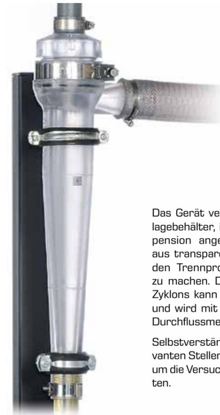
Kernelement von CE 225: transparenter Hydrozyklon zur optimalen Beobachtung des Trennprozesses
