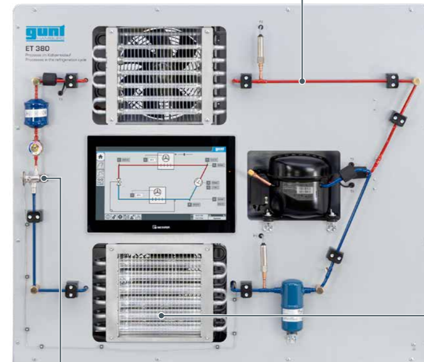
Der Kreisprozess spiegelt sich in der Rohrleitung und im Touchscreen wider
