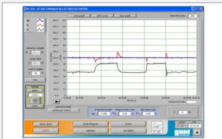
Capture d'écran du logiciel: régulation de débit, régulateur avec comportement PI avec différentes valeurs pour K_p et T_n , introduction d'une grandeur perturbatrice
