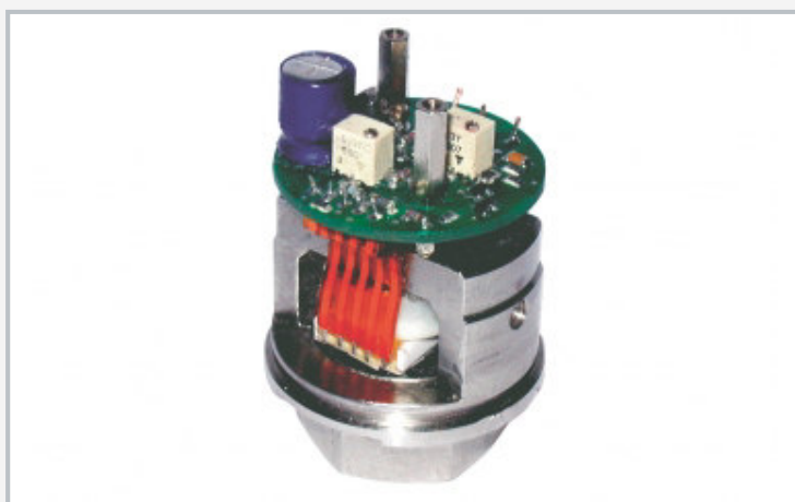
Structure interne d'un capteur de pression électronique
