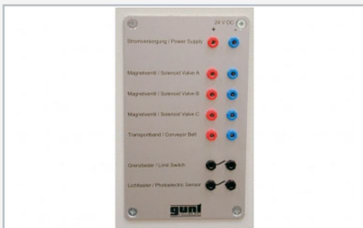
Connexions électriques des électrovannes et des capteurs
