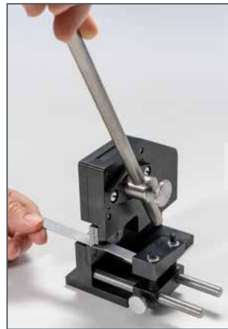
Blech schneiden mit der Hebelschere aus TZ 200.07
