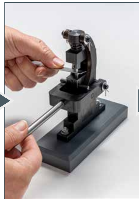
Löcher stanzen mit der Hebelpresse aus TZ 300
