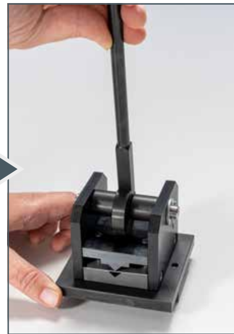
Werkstück formen mit der Biegepresse aus TZ 200.01
