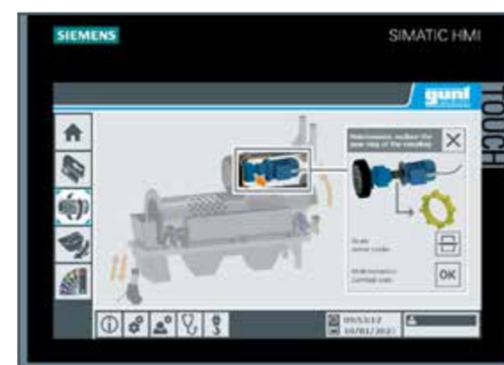
Le menu de l'écran tactile permet d'obtenir un aperçu de la situation. Tous les autres détails directement sur le crible à tambour via notre réalité augmentée.
