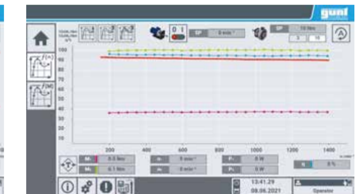
M = 10 \text{ Nm} = \text{konst} , n = 200 - 1400 \text{ min}^{-1} obere Kurven, rot: Wirkungsgradverlauf Sollwert
