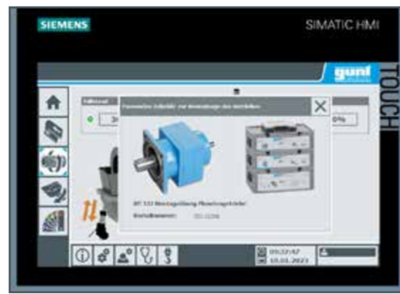
Hier wird der Vorschlag gemacht, das im Trommelsieb verbauten Planetengetriebe als separate Montageübung näher kennenzulernen.
