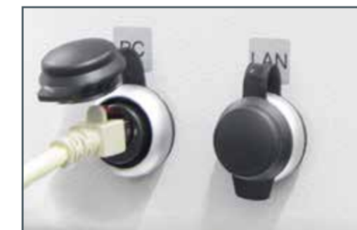
Anschlussbuchsen an der Seitenfläche des Schaltschranks von MT 173.
