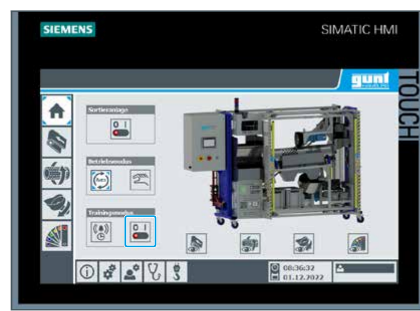
Am Touchscreen den Trainingsmodus einschalten. Betriebsstundenzähler befindet sich in der SPS. Die Wartungsintervalle für die verschiedenen Sub-Systeme sind simulierbar , d.h. einstellbar.
