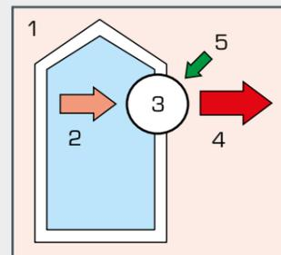
Lors du refroidissement, c'est la chaleur absorbée sur la pompe qui constitue l'aspect utile. Elle est retirée à la pièce et est émise à l'environnement. À cette fin, on a besoin d'énergie électrique pour faire fonctionner le compresseur de la pompe à chaleur.
