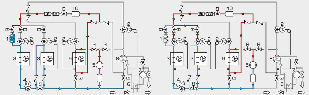
1 tube capillaire, 2 soupape de détente, 3 évaporateur, 4 régulateur de pression d'évaporation, 5 compresseur, 6 réservoir pour eau glycolée, 7 pompe, 8 échangeur de chaleur à serpentin, 9 échangeur de chaleur avec ventilateur, 10 réservoir
