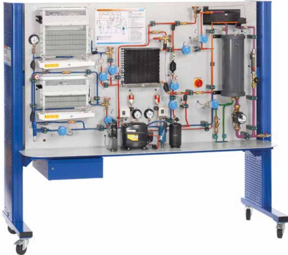
ET 405 permet de procéder à étude d'un grand nombre de configurations des composants. Un compresseur, un condenseur (échangeur de chaleur avec ventilateur) et deux évaporateurs avec ventilateurs (niveau de refroidissement normal et niveau de congélation) sont à disposition. Un échangeur de chaleur à serpentin peut au choix être utilisé comme évaporateur ou comme condenseur. Il relie le circuit de la pompe à chaleur avec un autre circuit, celui-ci étant rempli avec un mélange d'eau glycolée.
