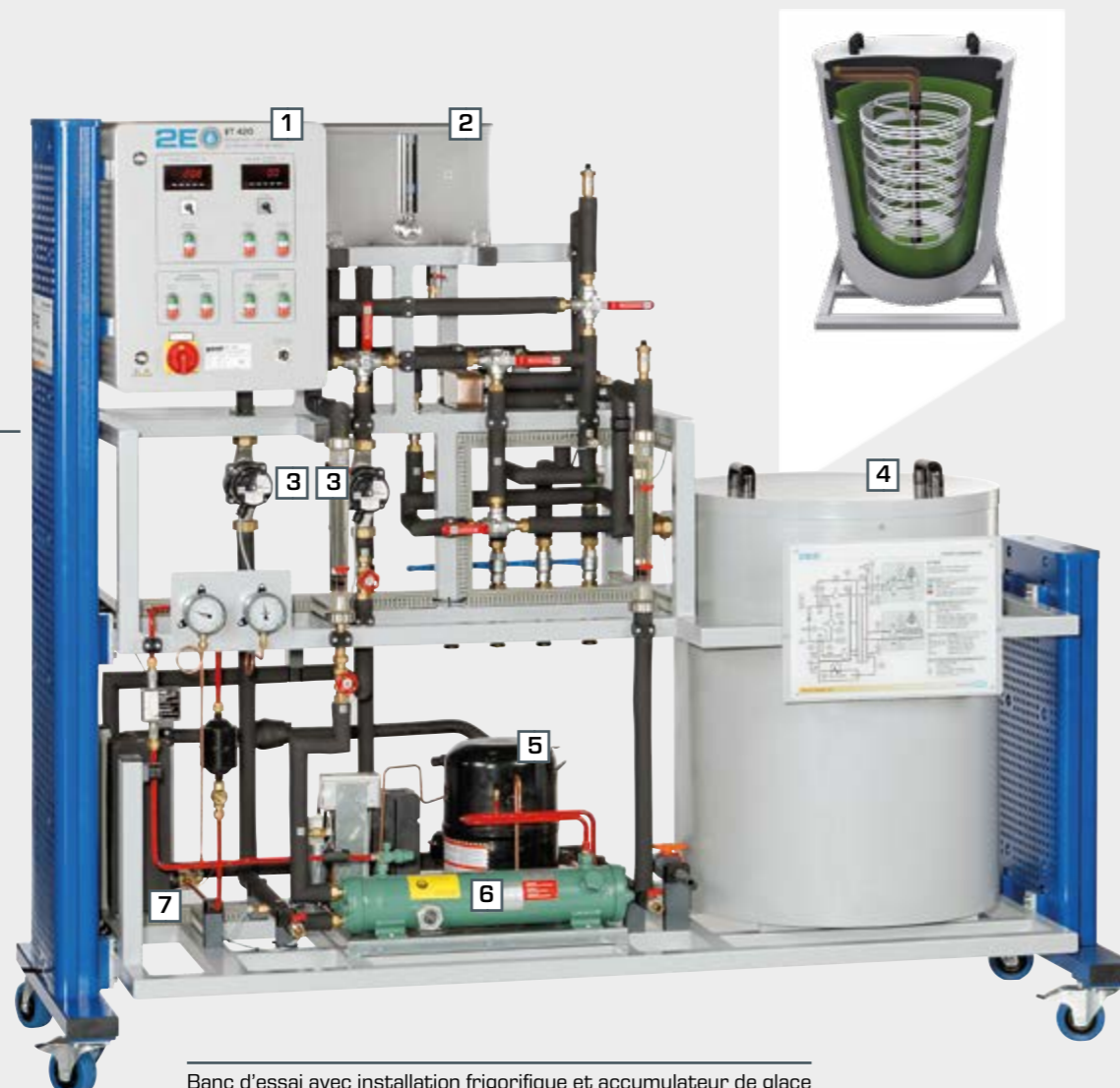
Banc d'essai avec installation frigorifique et accumulateur de glace
