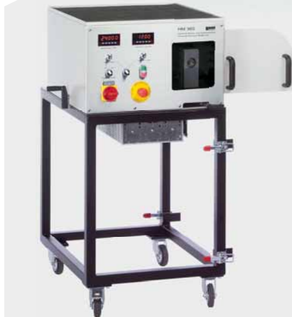
HM 365 Unidad universal de accionamiento y frenado
