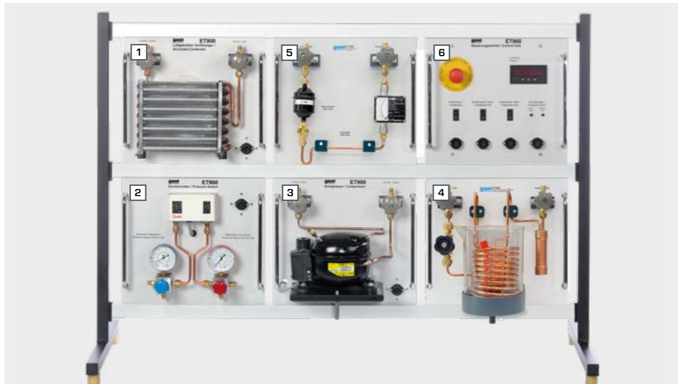
Kältekreislauf mit Verflüssiger und wasserbeaufschlagtem Verdampfer
