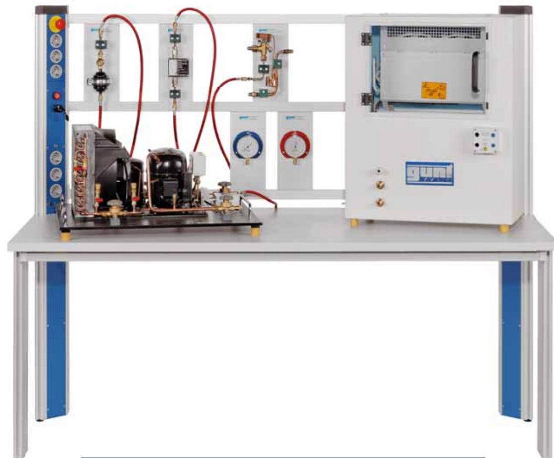
Poste de travail de laboratoire avec unité de base et composants pour essais de base
