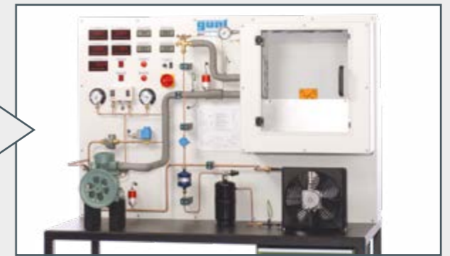
Installation frigorifique avec compresseur ouvert
