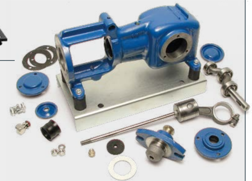
MT 1B4 Montage & maintenance: pompe à piston
