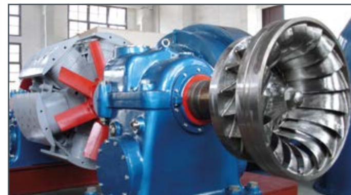
Turbine Francis à l'état démonté
