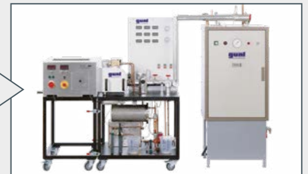
Centrale thermique à vapeur avec machine à vapeur à deux cylindres et générateur de vapeur électrique
