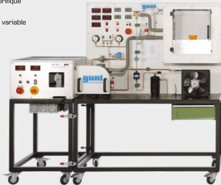
HM 365 Dispositif de freinage et d'entraînement universel ET 165 Installation frigorifique avec compresseur ouvert
