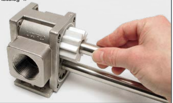
MT 186 Montage- und Instandhaltungsübung Zahnradpumpe
