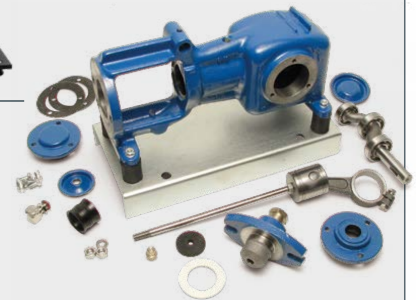
MT 184 Montage- und Instandhaltungsübung Kolbenpumpe
