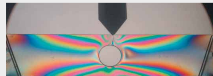
Sollicitation en flexion avec force centrale et étranglement de la coupe transversale
