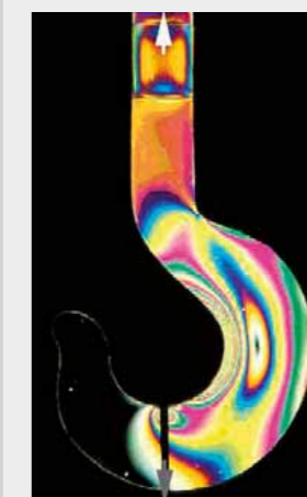
Gancho de una grúa sometido a una carga
