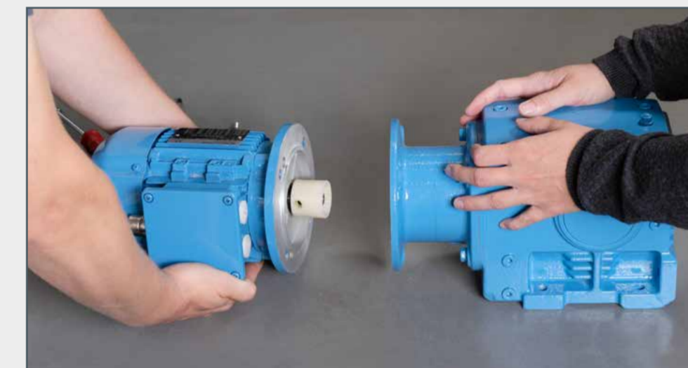
moteur et engrenage en tant que composants individuels
