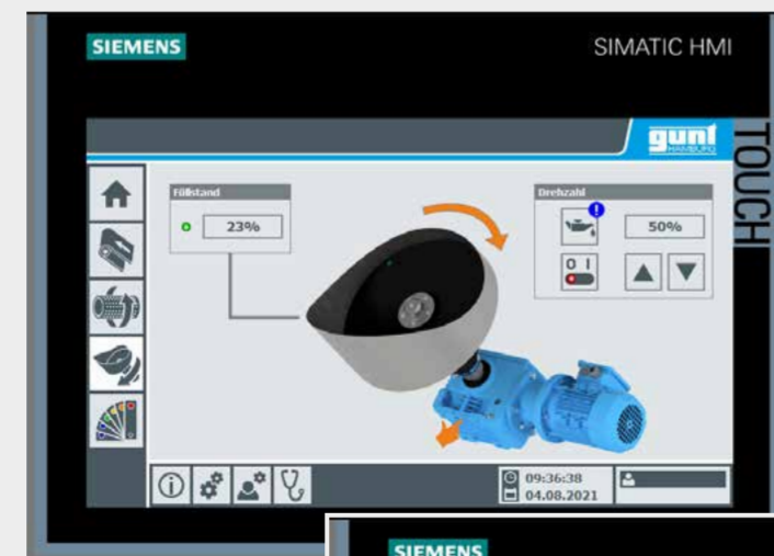
lubrification du joint de l'arbre nécessaire
