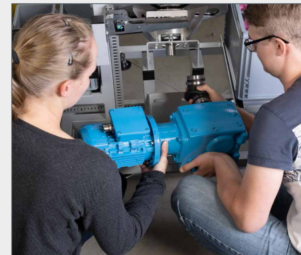
la chaîne cinématique est soulevée, le joint de cardan est libéré
