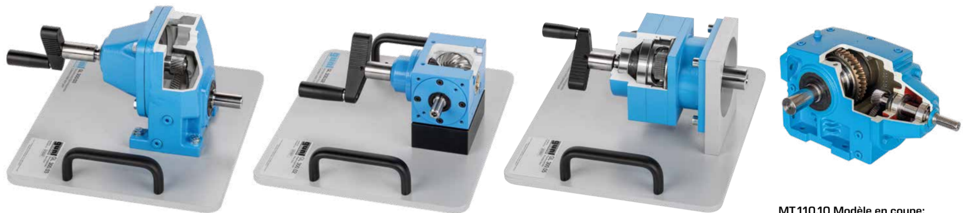
GL 300.03 Modèle en coupe: engrenage droit GL 300.02 Modèle en coupe: engrenage à roues coniques GL 300.05 Modèle en coupe: engrenage planétaire MT 110.10 Modèle en coupe: engrenage droit et à vis sans fin
