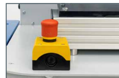
interrupteur d'arrêt d'urgence sur le plan de travail
