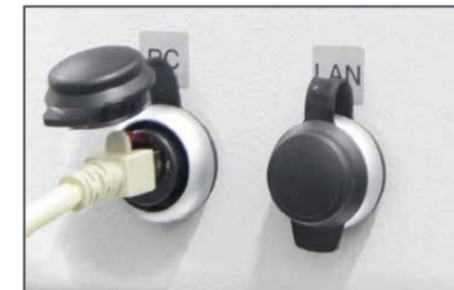
prises de raccordement sur la surface latérale de l'armoire de commande du MT 173
