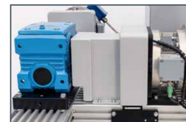
protection mécanique, arbre de sortie/accouplement, côté charge
