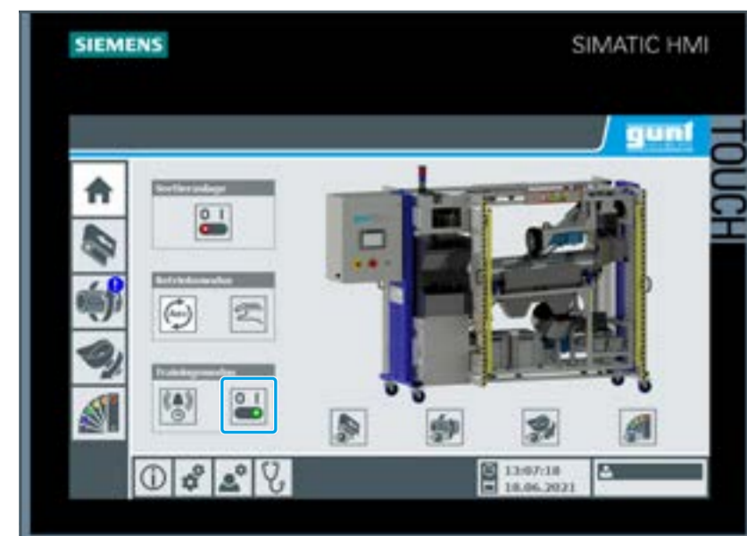
Am Touchscreen den Trainingsmodus einschalten. Betriebsstundenzähler befindet sich in der SPS. Die Wartungsintervalle für die verschiedenen Sub-Systeme sind simulierbar , d.h. einstellbar.
