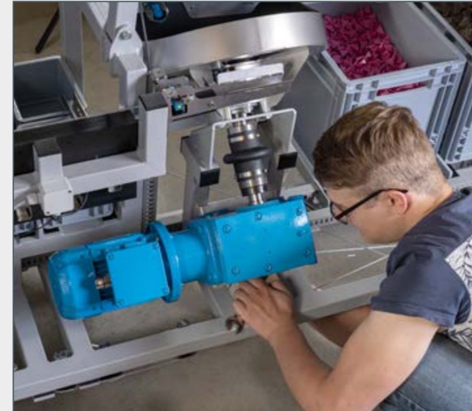
Schraubenverbindung zwischen Antriebsstrang und Gestell in MT 174 lösen
