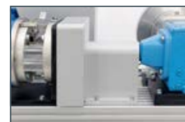
mechanischer Schutz, Antriebswelle/Kupplung, antriebsseitig
