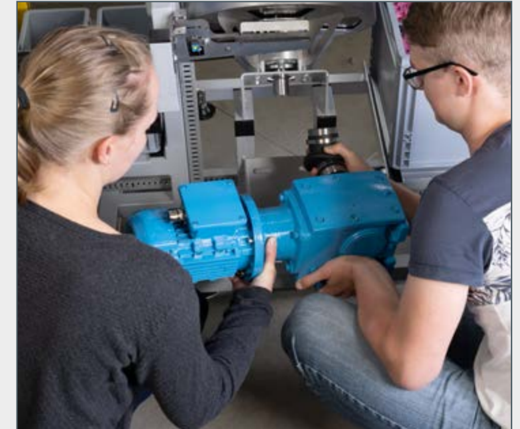
Antriebsstrang wird herausgehoben, Kardangeln werden gelöst
