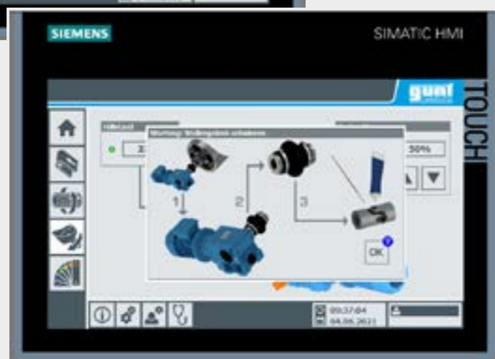
Wartungsschritte für die Schmierung des Wellengelenks
