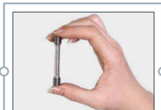
Retirer l'éprouvette de traction du chargeur
