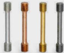
Éprouvettes de traction à coupe transversale circulaire selon DIN 50125, matériau: Al, Cu, acier, CuZn
