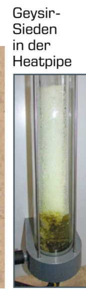
Erdwärmesonde mit Heatpipe-Prinzip
