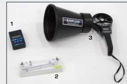
1 digitales Manometer, 2 Schrägrohrmanometer, 3 Anemometer
