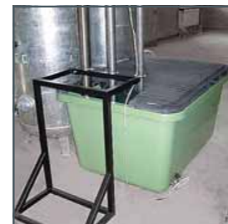
Au cas où la pièce offre un espace suffisant, il est possible d'intégrer un second réservoir d'aspiration à un niveau inférieur, en dessous de l'installation d'essai. La hauteur d'aspiration plus élevée obtenue ainsi facilite la réalisation de séries de mesures sur le comportement en service d'une pompe en ce qui concerne la valeur NPSH et la cavitation.
