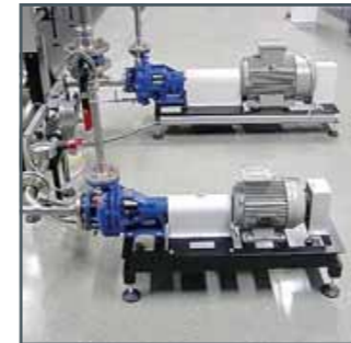
Pour les études sur les pompes, deux pompes centrifuges de tailles différentes sont à disposition.
