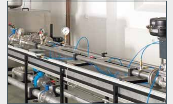
Zur Messung von Druckverlusten sind Rohrrecken mit verschiedenen Durchmessern und Materialien als Versuchsstrecken vorhanden. Neben hydraulisch glatten Rohrrecken steht auch eine Rohrstrecke mit definierter Rauigkeit zur Verfügung.
