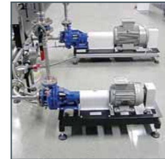
Für Untersuchungen an Pumpen stehen zwei Kreiselpumpen in unterschiedlichen Baugrößen zur Verfügung.
