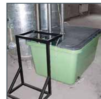
Bieten die Räumlichkeiten genügend Platz, kann wahlweise ein zweiter Ansaugbehälter in tieferliegender Ebene unter der Versuchsanlage eingebaut werden. Die dadurch entstehende größere Saughöhe erleichtert die Durchführung von Versuchsreihen zum Betriebsverhalten einer Pumpe in Bezug auf den NPSH-Wert und Kavitation.
