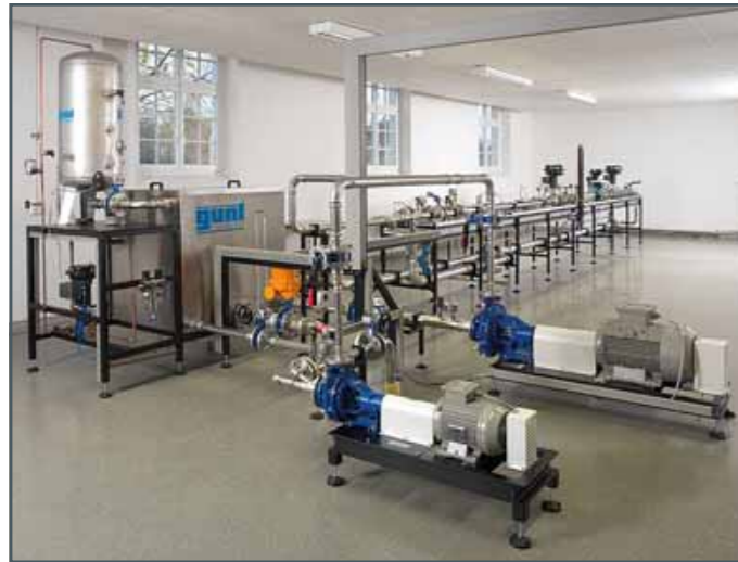
Versuchsanlage HM 124 in einem eingerichteten Labor mit optionaler Druckregelstrecke über einen Druckbehälter
