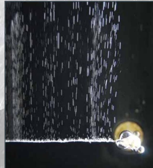
Bulles d'hydrogène produites par électrolyse utilisées comme produit de contraste.
