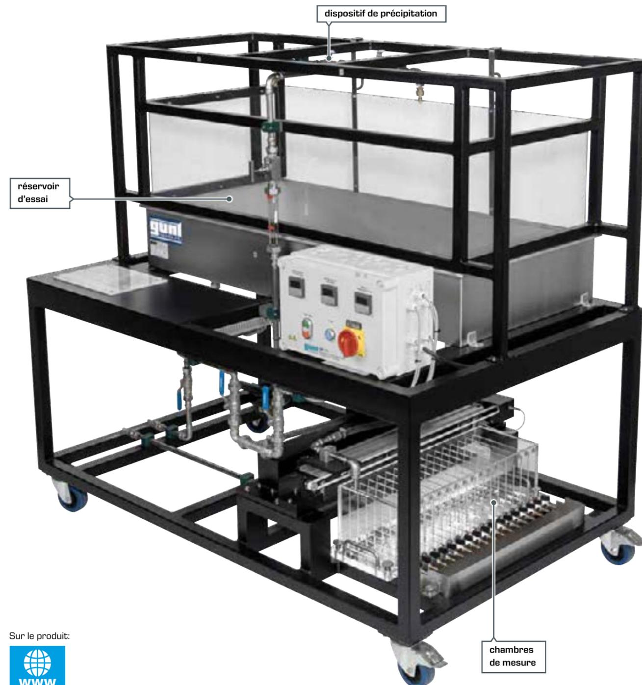
Un réservoir d'essai rempli de sable ou de graviers constitue l'élément central du HM 141. Des programmeurs permettent d'alimenter la surface d'essai en précipitations de durée et d'intensité différentes. Le drainage de la surface d'essai est assuré au choix soit par un tuyau de drainage, soit par une chambre d'évacuation se trouvant sur le côté du réservoir d'essai.
