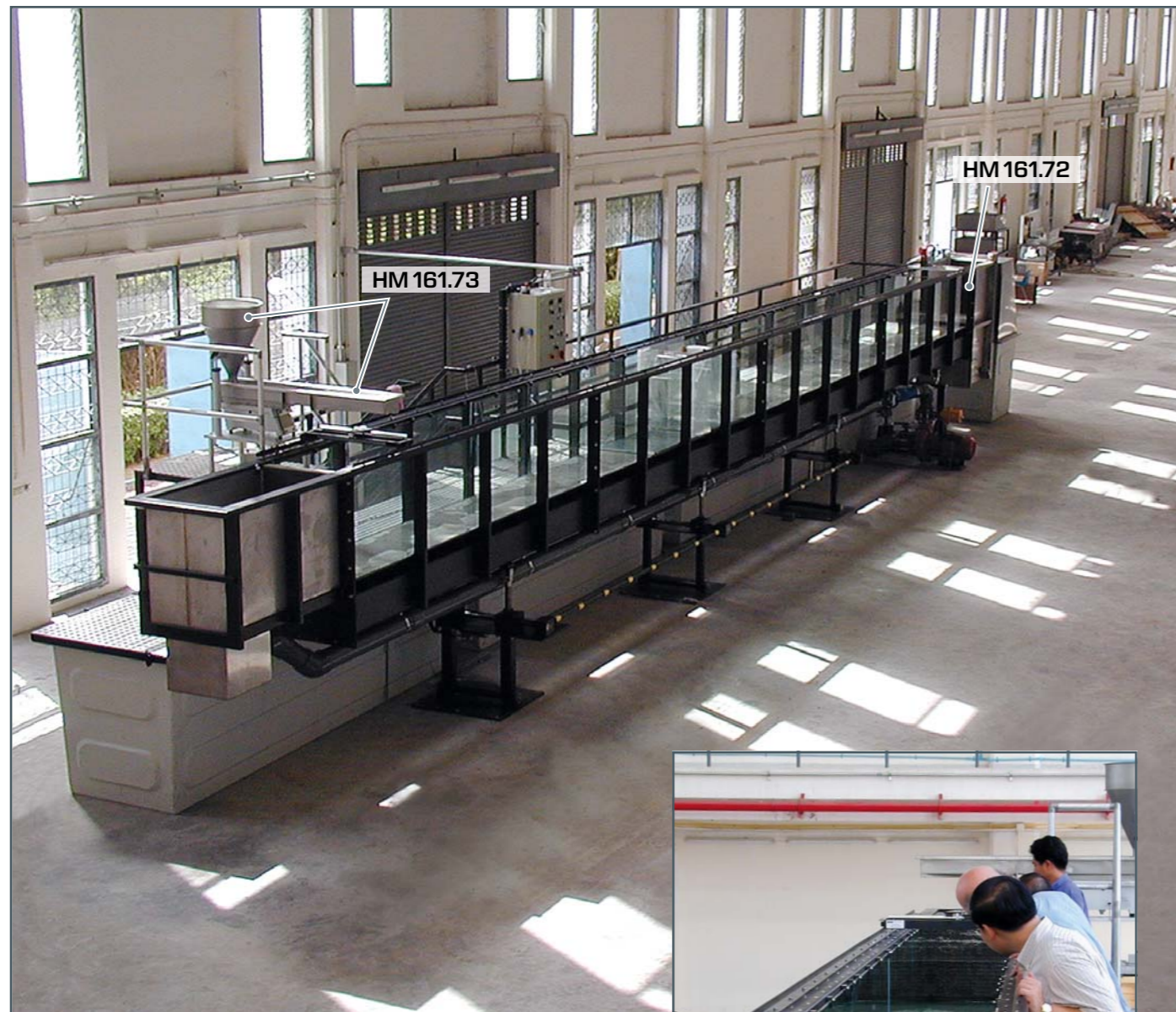
Canal d'essai HM 161 avec transport des sédiments. L'alimentateur en sédiments HM 161.73 est sur l'élément d'entrée. Le piège à sédiments HM 161.72 situé à l'extrémité de la section d'essai permet de séparer les sédiments.
