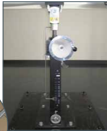
Vérin de stabilisation pour le système d'ajustage de l'inclinaison
