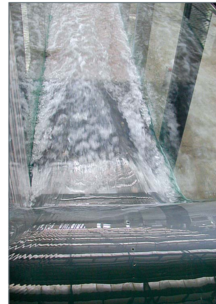
Vue du dessus avec débit au-dessus du déversoir à crête arrondie HM 161.34
