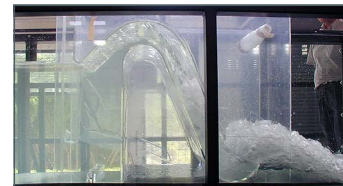
Débit dans le déversoir à siphon HM 161.36 actif
