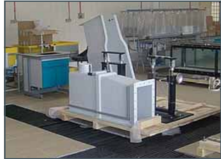
Élément d'entrée, élément de sortie et appuis pour canal
