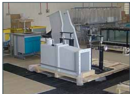
Zulaufelement, Ablaufelement und Gerinnestützen
