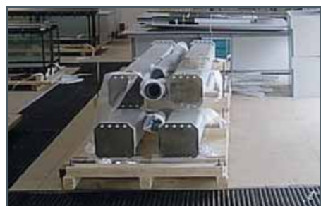
Zulaufelement, Ablaufelement und Gerinnestützen
