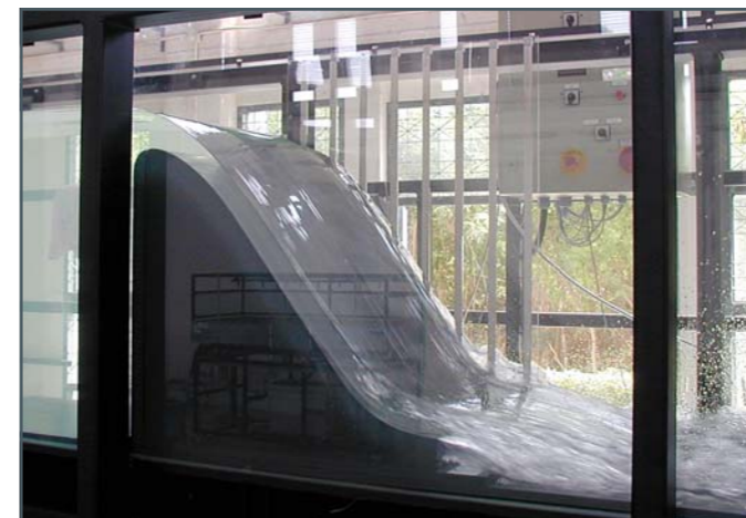
Seitenansicht beim Abfluss über das rundkronige Wehr HM 161.34
