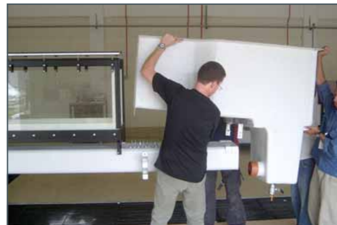
Das Zulaufelement wird auf den Hilfsträger gehoben, ausgerichtet und mit der Versuchsstrecke verbunden.
