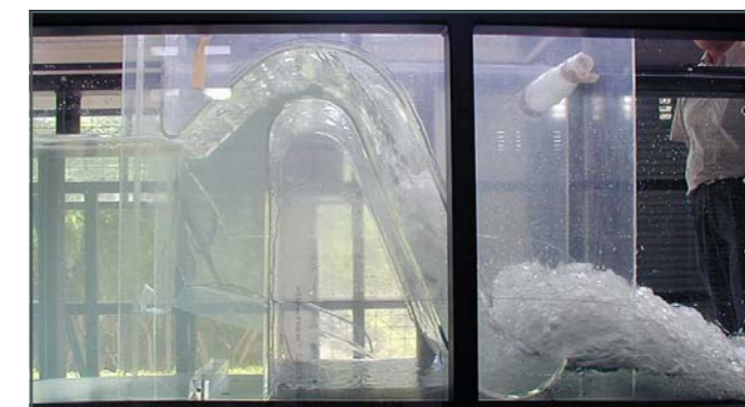
Abfluss im aktiven Heberwehr HM 161.36
