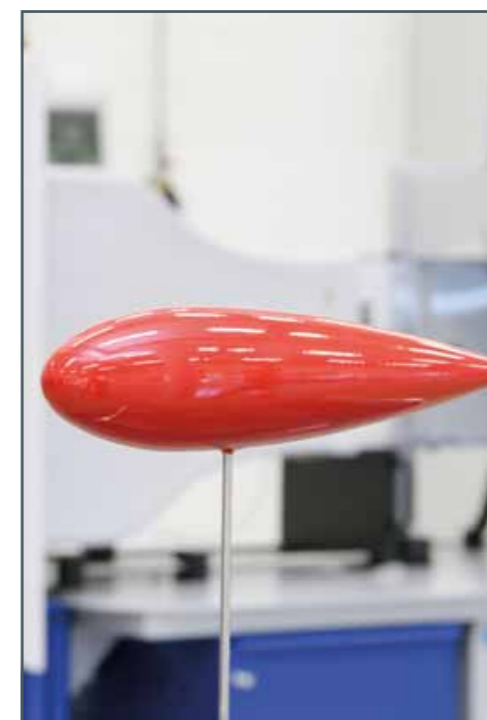
Mesure des forces de la portance et de traînée sur le corps de lignes de courant avec le capteur de force à deux composants
