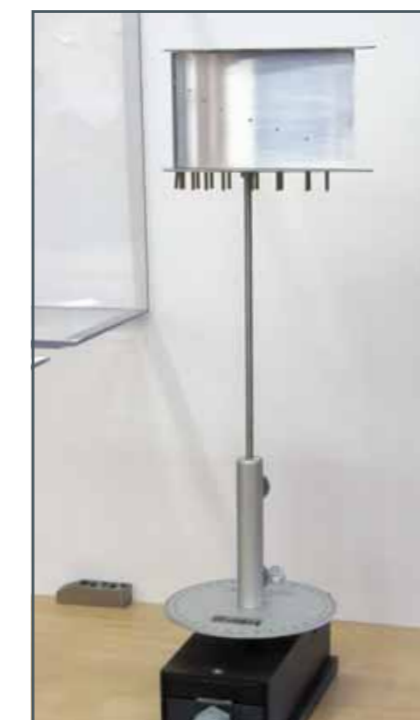
Répartition de la pression sur une aile soumise à un écoulement autour de corps
