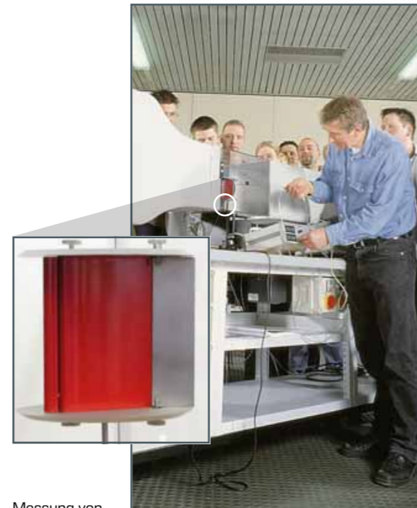
Messung von Auftriebs- und Widerstandskräften in Abhängigkeit vom Anstellwinkel an einer Tragfläche mit Vorflügel und Spreizklappe
