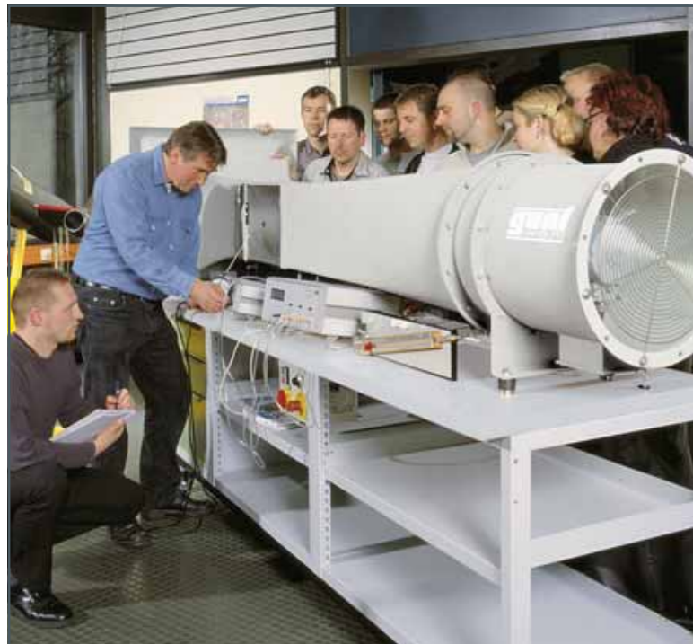
Curso de formación en el túnel de viento abierto HM 170 en la Escuela Técnica de Ingeniería Aeronáutica de Hamburgo (Alemania)
