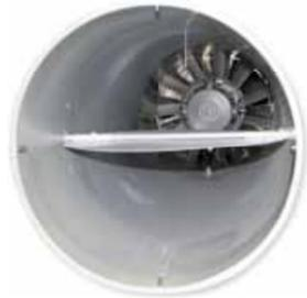
Vanne papillon à l'extrémité de la section de mesure pour l'ajustage du débit volumétrique.
