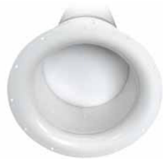
Eine sorgfältig gestaltete Düsenkontur und ein Strömungsgleichrichter am Lufteintritt sorgen für turbulenzfreie Anströmung der Laufschaufeln.
