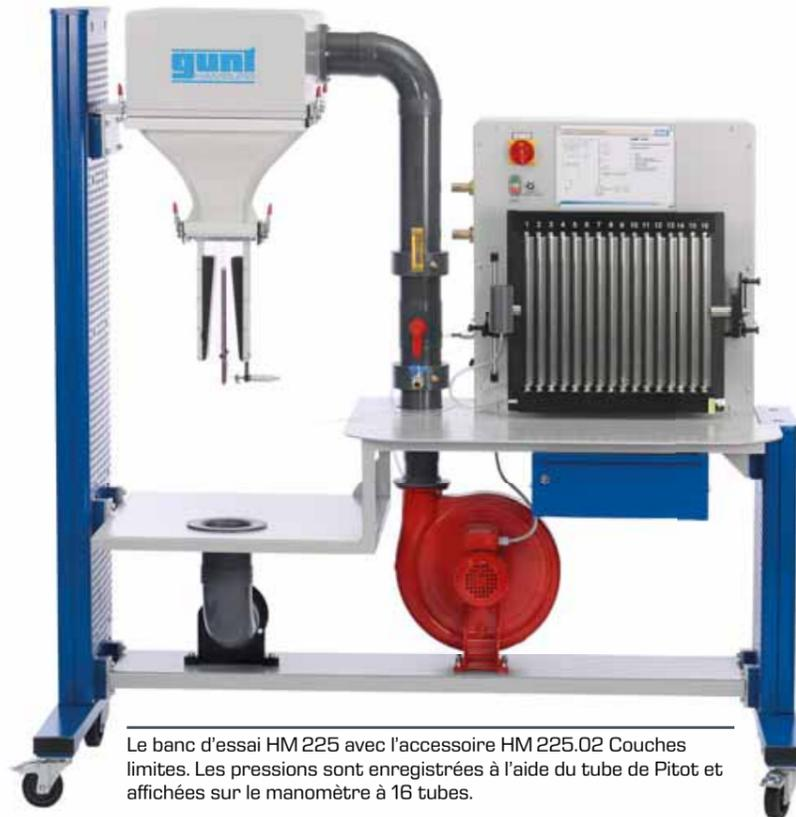
Le banc d'essai HM 225 avec l'accessoire HM 225.02 Couches limites. Les pressions sont enregistrées à l'aide du tube de Pitot et affichées sur le manomètre à 16 tubes.
