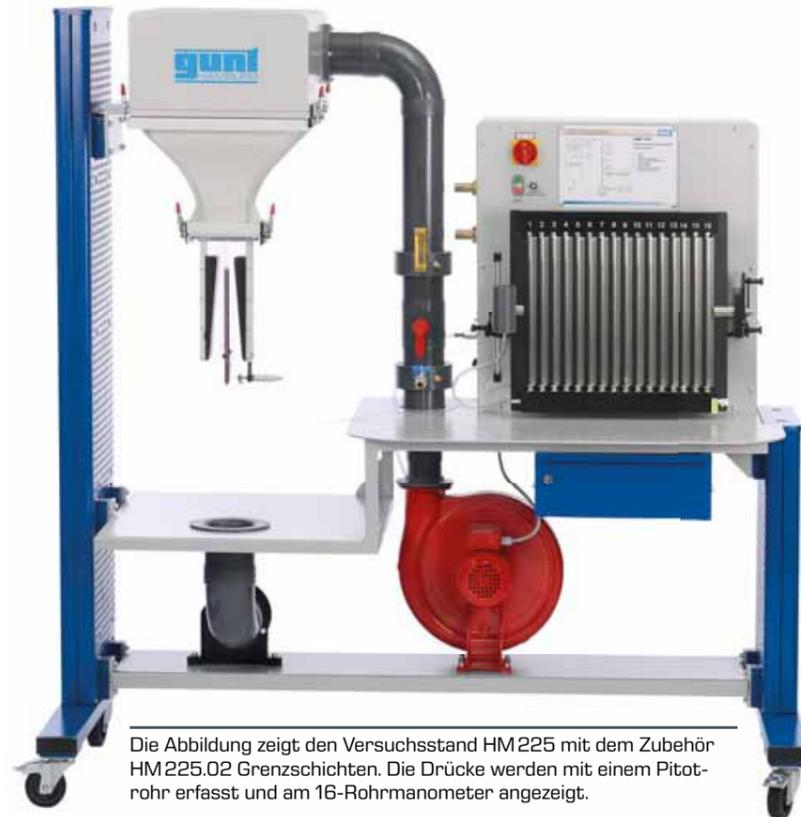
Die Abbildung zeigt den Versuchsstand HM 225 mit dem Zubehör HM 225.02 Grenzschichten. Die Drücke werden mit einem Pitotrohr erfasst und am 16-Rohrmanometer angezeigt.
